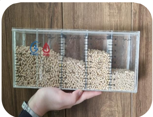
تصویر ۷- الک مخصوص کنترل خاکه‌دان؛ دان پلت با قطره‌های متفاوت دای
